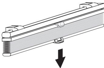
Einfaches entfalten bzw. schließen des Paketes durch Bedienung der Unterschiene.
