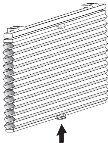
Durch stufenloses verschieben der Ober- und Unterschiene erhalten Sie immer den perfekten Sonnenschutz
