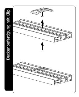
Deckenclip an der Decke befestigen (ggf. Unterlegscheibe zum ausgleichen verwenden) Flächenvorhangschiene einhängen
