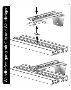
Deckenclip an dem Wandträger festschrauben Wandträger an der Wand befestigen Flächenvorhangschiene in den Clip einhängen
